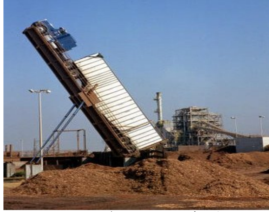
شاحنة تفرغ شحنتها من نشارة الخشب لا استخدامها كمصدر وقود لانتاج الطاقة الكهربائية
